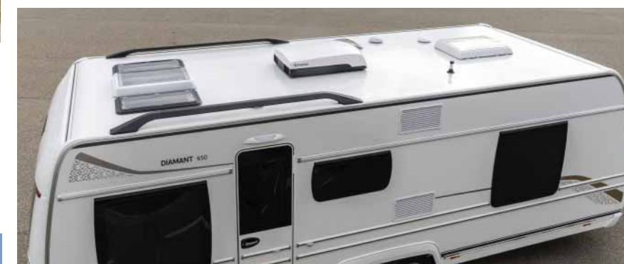
Toit en polyester renforcé GFK (PRV : Polyester Renforcé en fibres de Verre)
